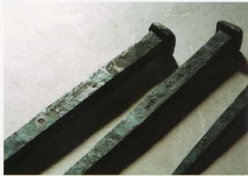
歴史的な建築物に使われた、様々なサイズや形の釘。表面にはハンマーで叩いた痕跡が鮮やかに残る。
